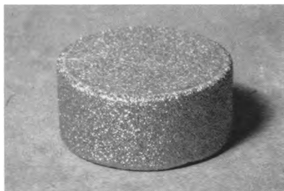
Fig. 2. Zirconium coated uranium disk, actual size
